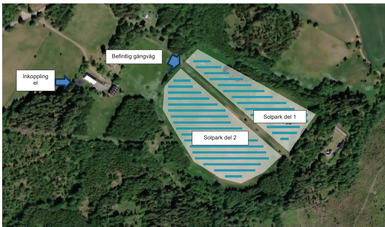
Figur 2 – Verksamhetsområdet (3,9 hektar) streck markerat ovan samt befintlig gångväg genom. Inkoppling av projektet planeras ske till Vattenfalls elnät markerat ovan.
