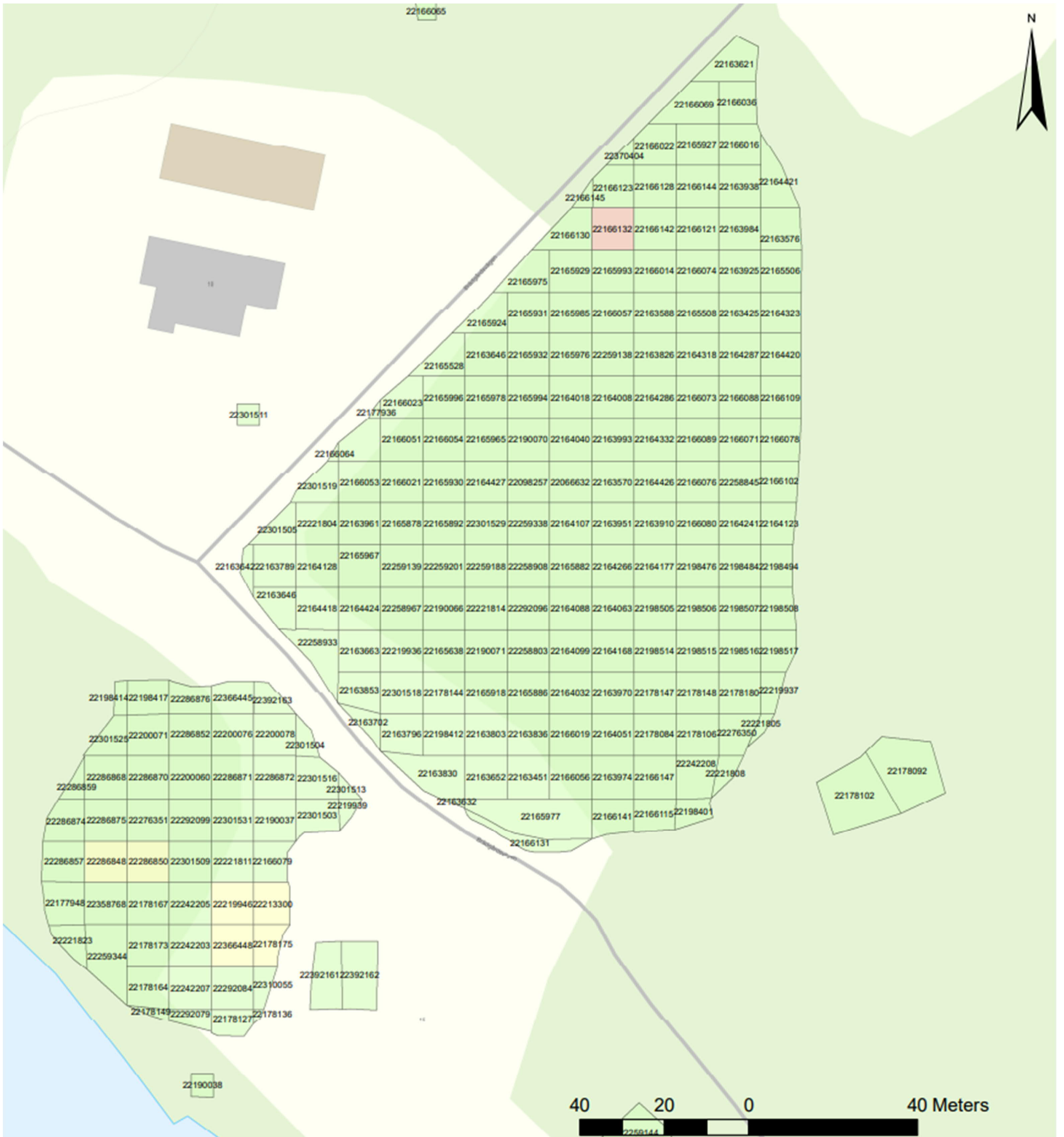
Figur 8b: Kvarlämnade metallhalter i slutliga schaktbottenar. Grön yta avser halt lägre än KM-riktvärdet, gul avser halt högre än KM-riktvärdet lägre än MKM-riktvärde och aprikos avser halt över MKM-riktvärde (inga halter över MKM). Källa: bearbetade utklipp av ritningar M103a-c.
