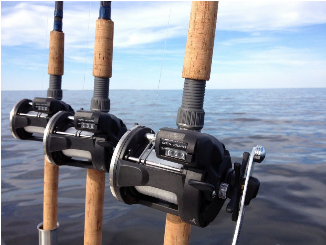
Figur 6. Trollrullar med räkneverk för att kunna avgöra hur långt linsläpp man har efter båten. Foto: Länsstyrelsen.
