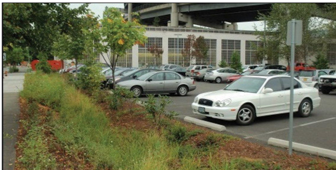
Figur 8. Exempel på infiltrationsstråk ansluten till parkeringsytor
